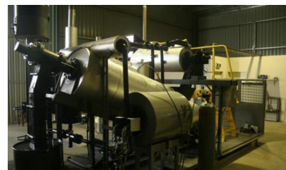
Lò nhiệt phân eGenesis CR-2 sản xuất TSH và khí tổng hợp.
